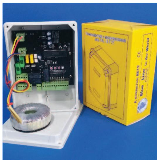
Programmatore con regolazione di forza e rampa a fine corsa universale per cancello battente
