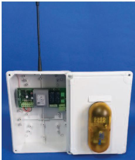
Programmatore per serranda con programmazione digitale a tempo o fine corsa
