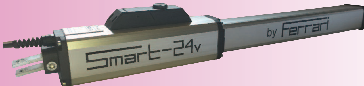
Actuador electromecánico lineal 24 V 50 W - Carrera 37 cm. Mod. SMART-24 V irreversible
