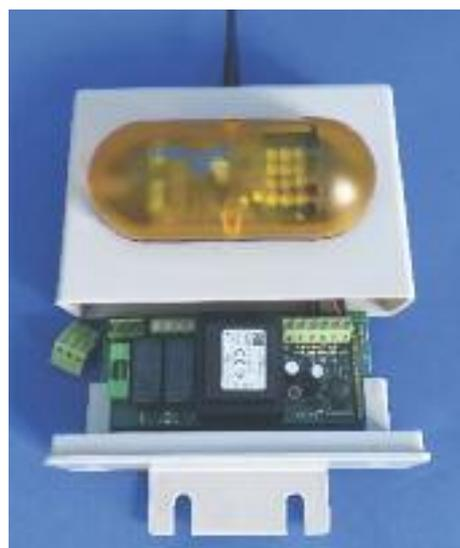
Programador para compuerta con programación digital a tiempo o fin de carrera
