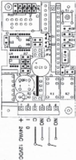
RECEPTOR DE RADIO ROLLING CODE DE 1/2 CANALES
