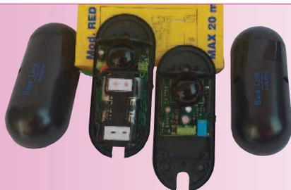
Cellule photoélectrique à lentille fixe
