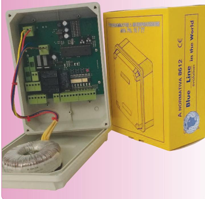
Programmateur avec régulation de force et rampe de fin de course universelle pour portail battant à 2 vantaux et coulissant
