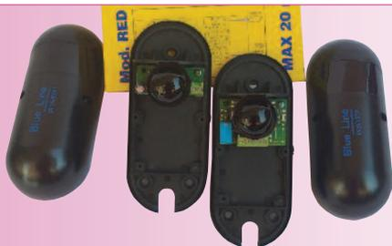
Cellule photoélectrique à lentille fixe
