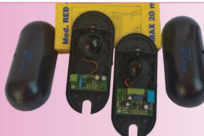
Cellule photoélectrique avec objectif 0°-90°-180°
